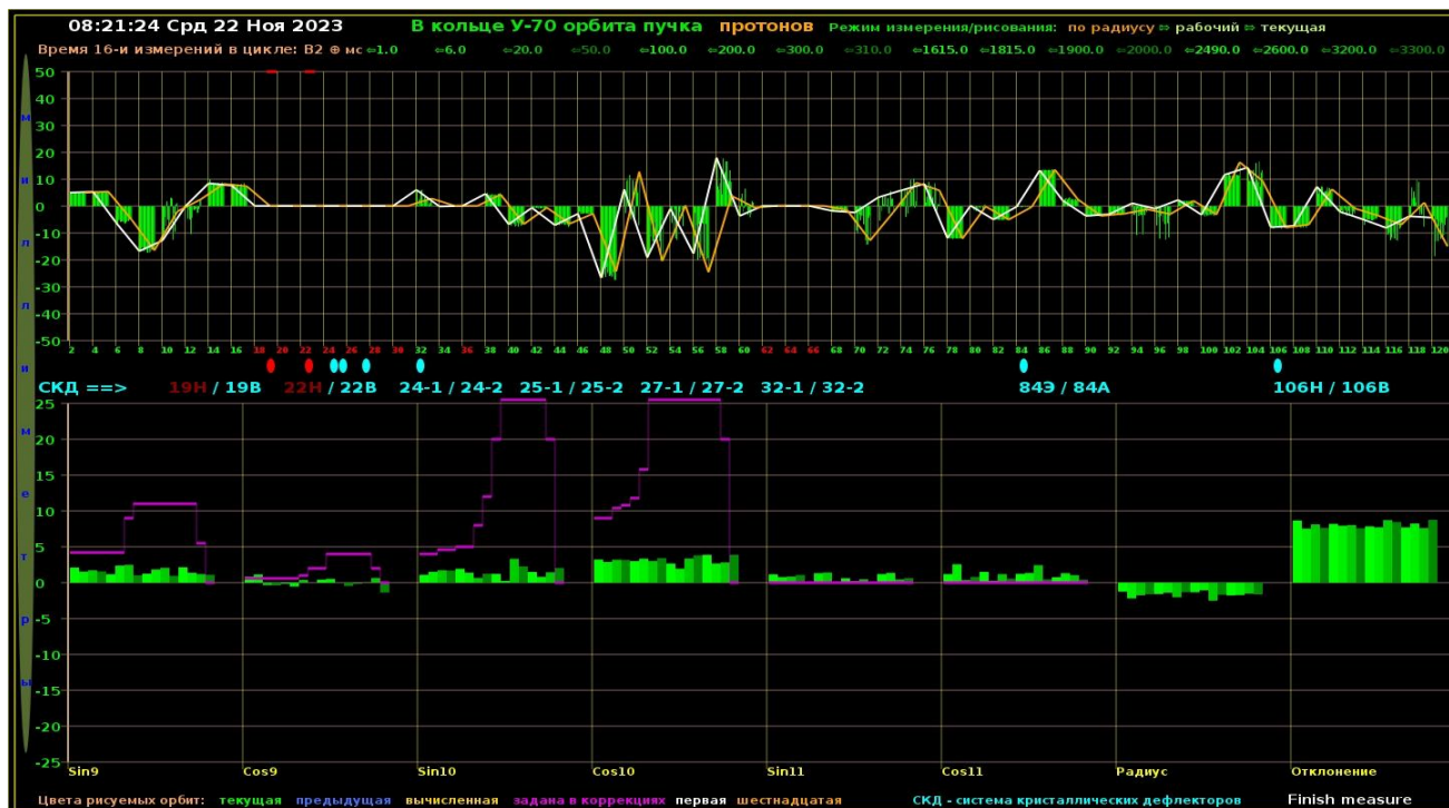
Рис. 5. Орбита пучка протонов в У-70 и кристаллические дефлекторы.
