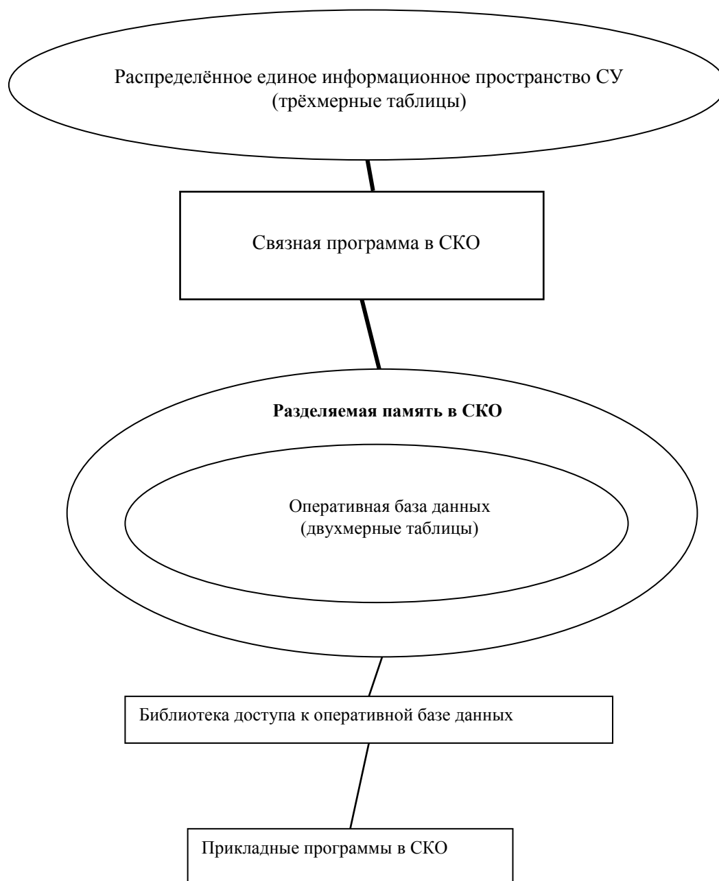
Рис. 4. Схема организации логической интеграции СКО в СУ У-70.
